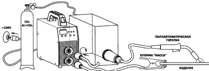
**Внимание!** В качестве защитного газа применяется при сварке чёрных металлов в простейшем случае углекислый газ " $\text{CO}_2$ ", а при сварке алюминия только инертные газы типа аргон " $\text{Ar}$ ", иногда дорогой гелий " $\text{He}$ ", как альтернатива для нержавеющих и высоколегированных сталей часто применяются смеси в различных пропорциях " $80\%\text{Ar}+20\%\text{CO}_2$ ". Использование других газов только по согласованию с производителем оборудования.
